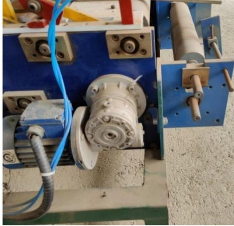
*Figura 111: Acoplamiento de Motor y reductor*
