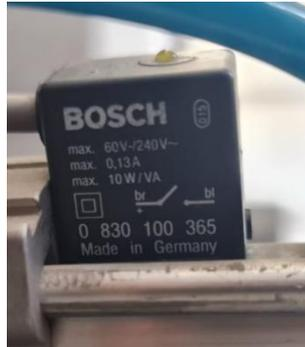
*Figura 128:* Sensor magnético de posición de 2 hilos
