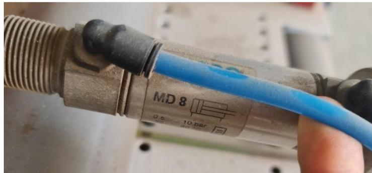
*Figura 126: Pistón de sujeción de doble efecto*
