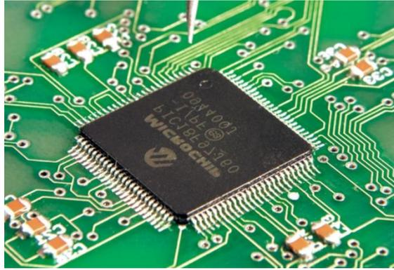
Figura 50: Circuitos integrados
