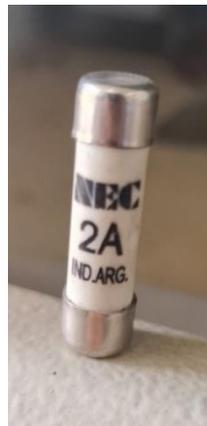
*Figura 116:* Fusible para el circuito de control
