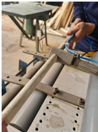
*Figura 174:* Guías mecánicas para la extracción del material
