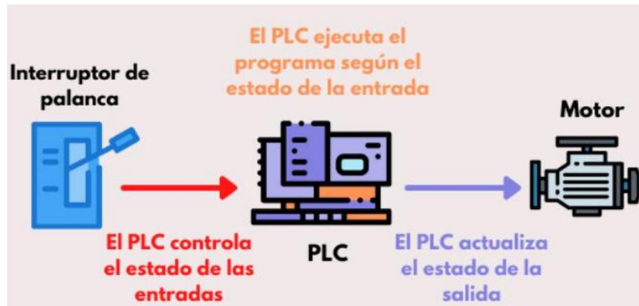
Figura 70: Funcionamiento de un PLC
