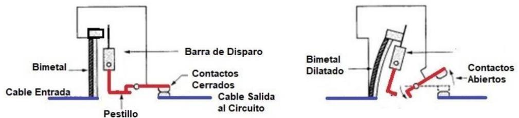
Figura 21: Protección térmica del interruptor termomagnético
