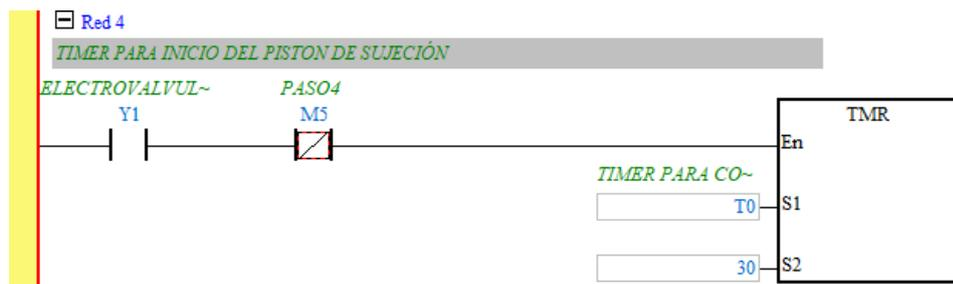
Figura 139: Timer para inicio del pistón de sujeción - Red 4
