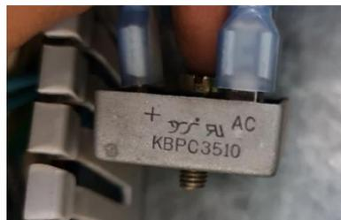
*Figura 119:* Puente de diodos KBPC3510
