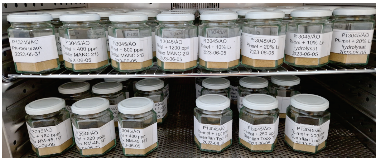
Figur 2 Akselerert lagringsforsøk av melprøver i varmeskap ved 40\text{ }^{\circ}\text{C}
