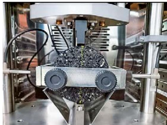
Figure 1 : Essai de rigidité IT-CY, SN EN 12697-26.
