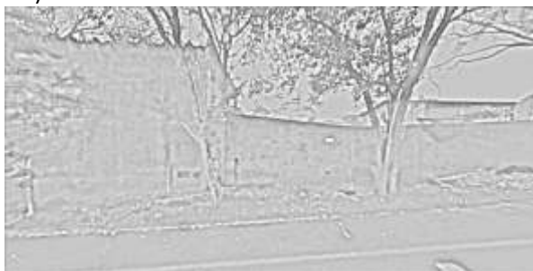
Figura 15. Imagem resultante da aplicação da divisão entre a imagem em tons de cinza e a imagem da suavização gaussiana (Figura 14).
