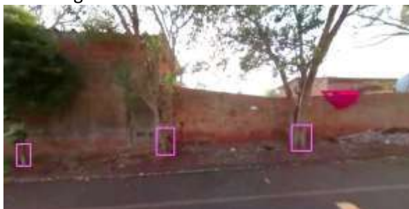
Figura 23. Retângulos representando as regiões encontradas pelo algoritmo contendo possivelmente troncos das árvores presentes na imagem.
