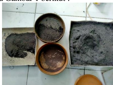
Gambar 1. Proses penyanjangan abu daun bambu.
