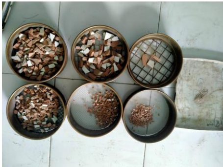
Gambar 2. Proses penyaringan limbah pecahan keramik
