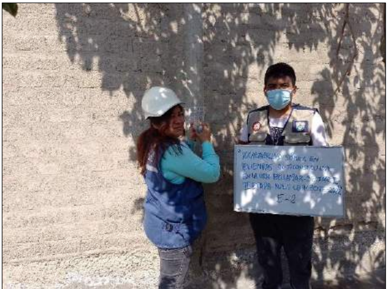
Figura N° 253 –Esclerometría E-2 Se observa los golpes con el esclerómetro (total 16). Columna
