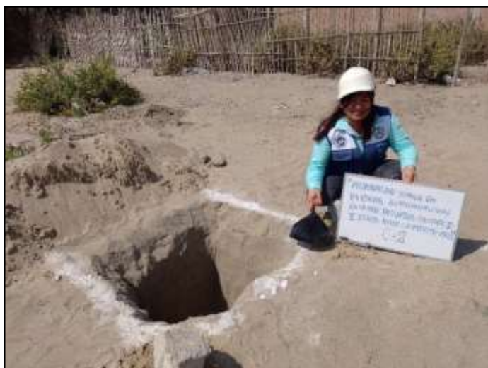
Figura N° 241 –Toma de muestra de Calicata C-2
