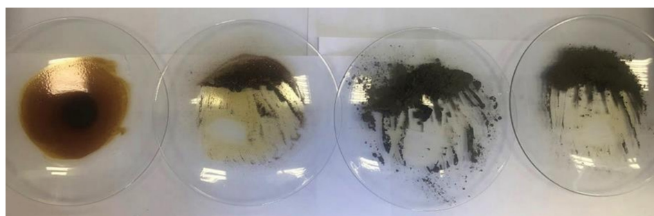
Рис. 5. Сорбция нефтешлама на твердой поверхности: слева направо: образец НП, кварцевый песок, прокаленный сорбент, модифицированный сорбент.
