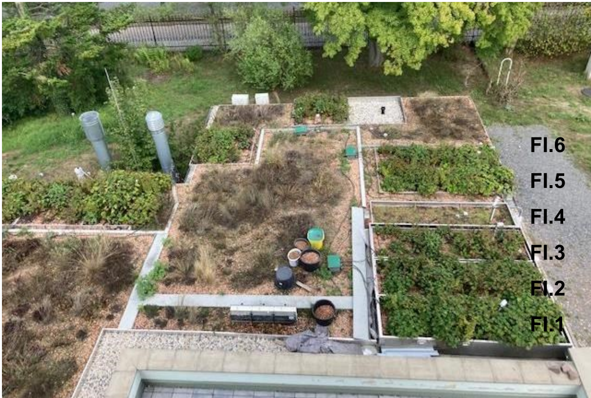
Abbildung 7.1-4: Östlicher Teil des Gründachs mit den Feldern mit differenzierter Grauwasserbewässerung. Die Felder Fl. 1-I bis 1-VI stehen im Fokus der Auswertung der Daten des Infrarotsensors. (Foto: V. Goldberg, 25.08.2022).
