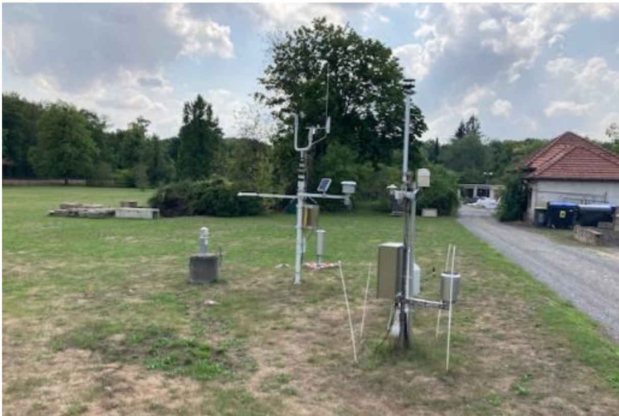
Abbildung 7.1-5: Automatische Klimastationen der Landeshauptstadt Dresden (rechts) und des Deutschen Wetterdienstes (links), 50 m südöstlich des Gründachs im Botanischen Garten (Foto: V. Goldberg, 25.08.2022).
