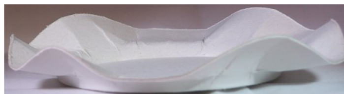
Abbildung 4: Teilweise eingezogenes Formteil ohne Faltenhalter aus HAUPTMANN (2010)
