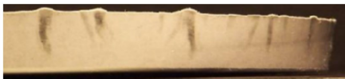
Abbildung 7: Ziehteil mit Zipfelbildung und lokalen Schwärzungen aus HAUPTMANN (2010)
