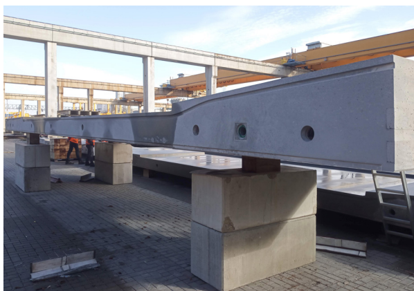
Bild 3 Fertiggestelltes direkt befahrbares Fahrbahnmodul im Werk mit Blick auf die geschliffene Stirnfläche (links) und Detail der eingelegten Tübbingdichtung (rechts) Fotos: Th. Frieß
