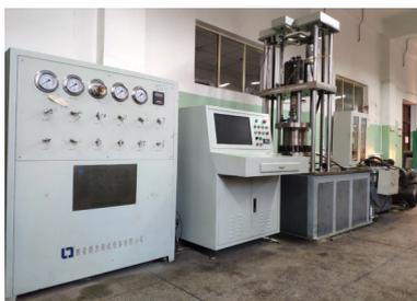
图 1 WYS-800 三轴瓦斯渗流试验装置
