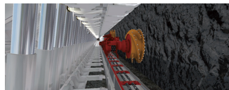
图 8 采煤机智能截割显示界面
