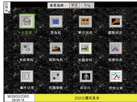
图 4 采煤机智能截割控制系统界面
