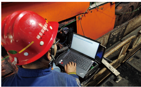
图 9 井下采煤机 5G 通信应用测试
