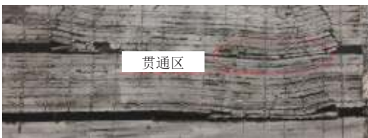
图 18 上下煤层覆岩贯通区结构模型
