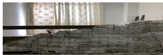
图13 上煤层开采后边坡破坏半“金字塔”结构模型
