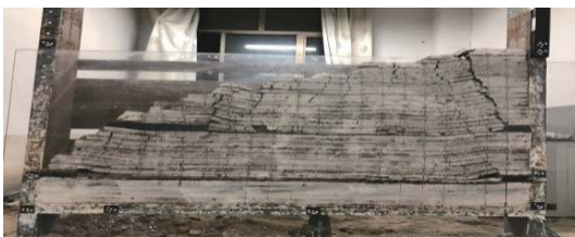
图 19 边坡变形破坏结构模型
