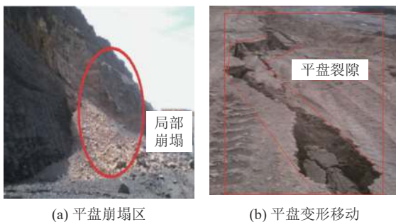
图 27 边坡平盘局部滑移及移动
