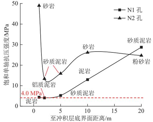
图 2 N1 孔和 N2 孔饱和单轴抗压强度与冲积层底界面距离关系曲线
