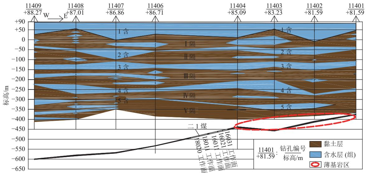
图1 北翼冲积层东西剖面图
