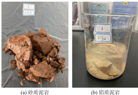
图 6 砂质泥岩 24 h、铝质泥岩 30 min 后崩解状态
