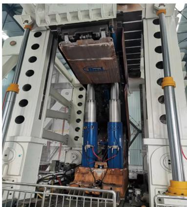
图10 两柱掩护式支架加载试验
