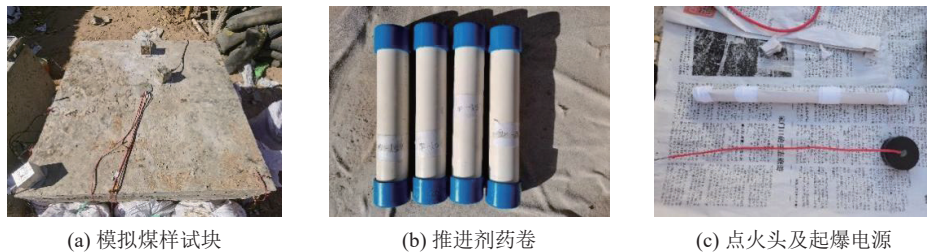
图 1 航天固体推进剂模拟煤样致裂试验
