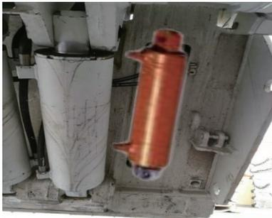
图 10 磁致伸缩位移传感器实物
