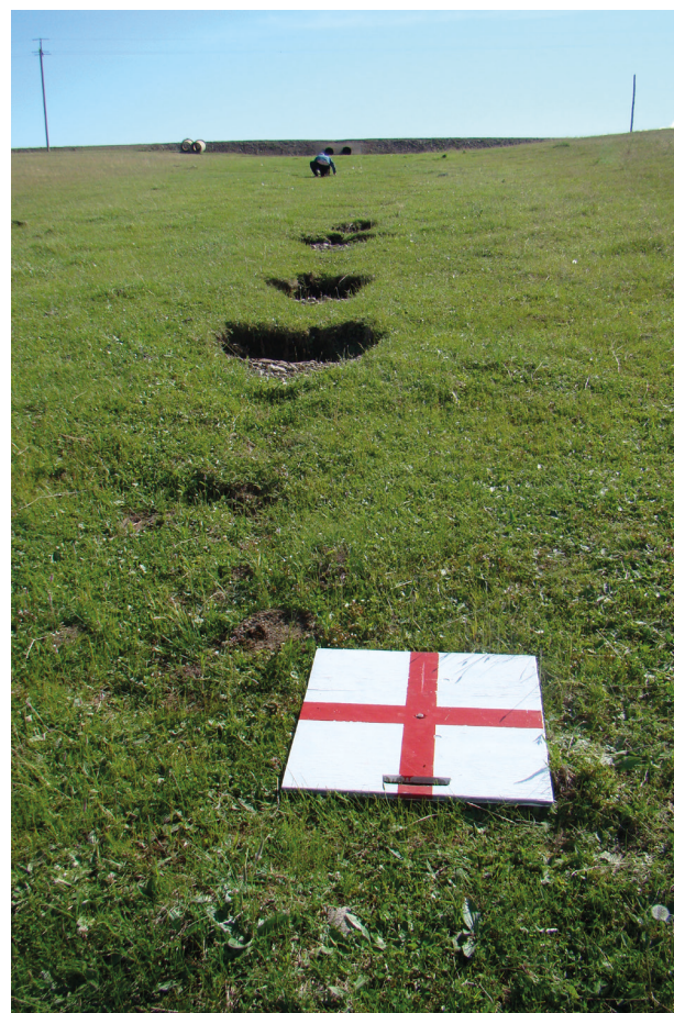
Рис. 3. Вид искусственной контрольной точки для БПЛА аэрофотосъемки ключевого участка.
