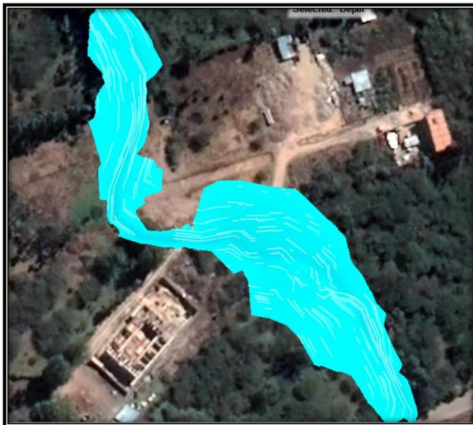
Modelamiento de caudales para los diferentes periodos de retorno obtenidos mediante el método racional.
