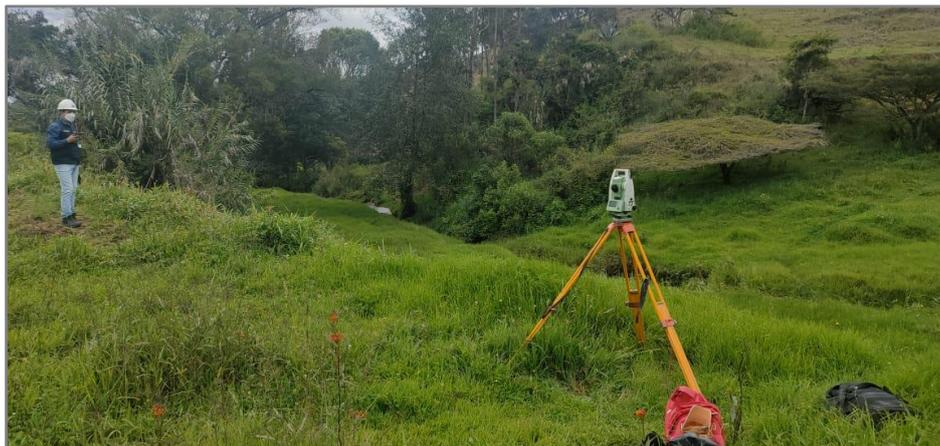
*Fig. 29: Estacionamiento de Estación Total*
