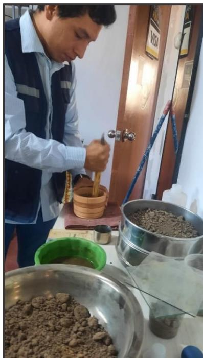
*Foto 30. Saturación del material y Tamices reglamentados para realizar el análisis granulométrico.*
