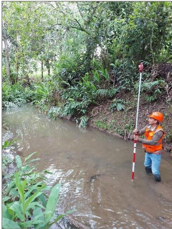
*Fig. 33: Batimetría del cauce de la quebrada*
