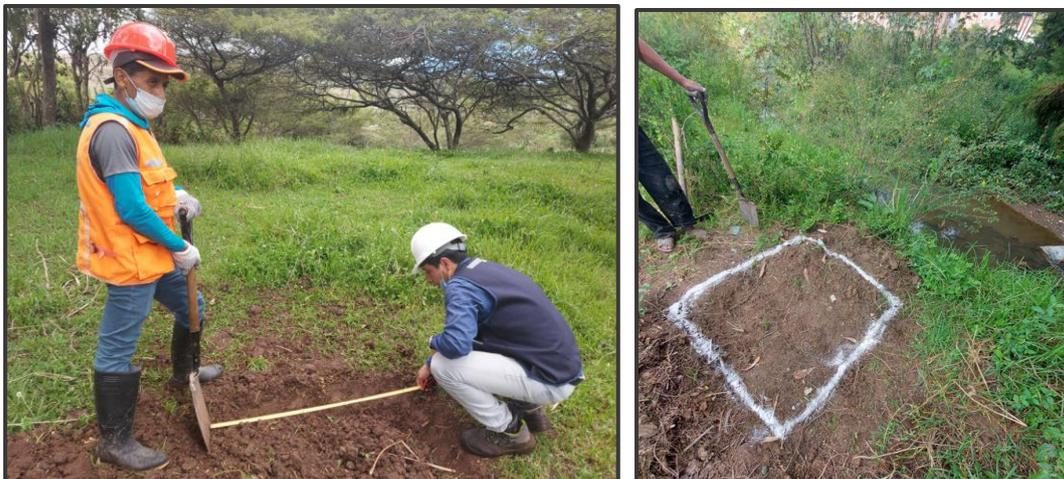
Foto 16. Rayado y profundidad de la calicata realizada a 1.5m.
