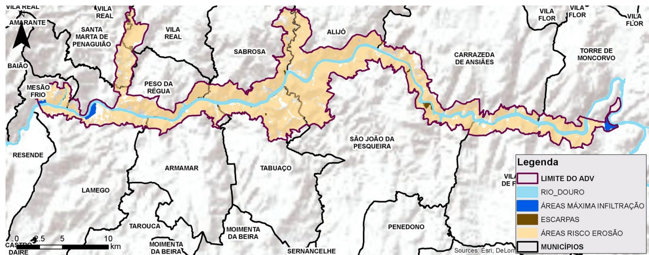
Figura 10. Localização das áreas de máxima infiltração no Alto Douro Vinhateiro, que resultaram da justaposição das unidades geológicas representadas nas cartas geológicas com a morfologia representada no ortofotomapa.
