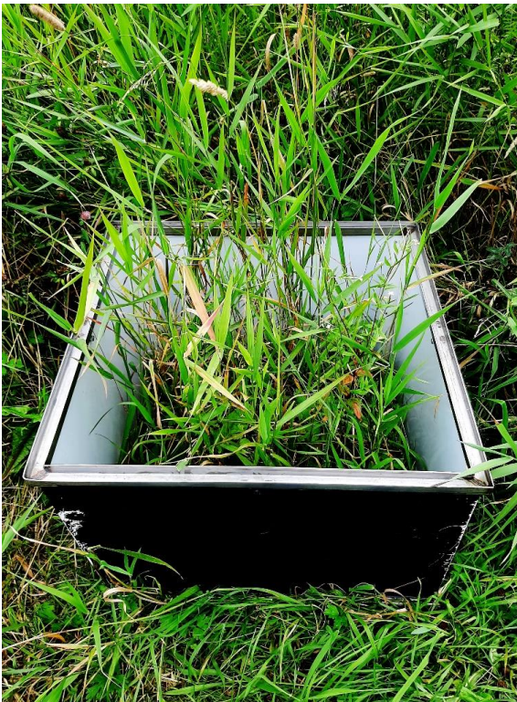
Kuva 19. Kammiomenetelmässä mittauskammio asetetaan kaasutiiviisti alumiinikauluksen vedellä täytettyyn uraan. Kuva: Tuula Larmola
