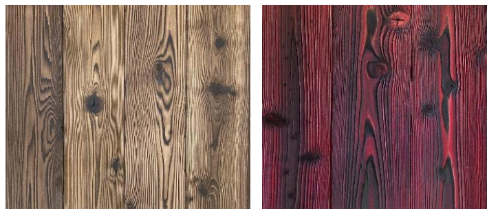
Figure 4. Perbedaan tampilan permukaan kayu original dan yang diwarnai [Source : Reference [7]]
