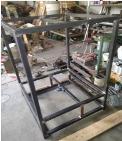
**Gambar 7.** Rangka mesin
