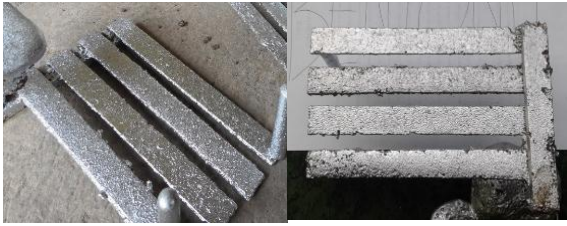
Gambar 1. Hasil Coran dengan Pengikat Bentonit 15%
