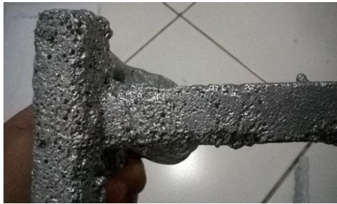
Gambar 2. Cacat pada Benda Cor
