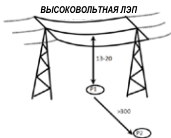
Рис. 9. Схема дистанционной регистрации ГИТ в ЛЭП дифференциальным методом. P1 и P2 – точки расположения магнитометров, расстояния указаны в метрах [подготовлена авторами].
