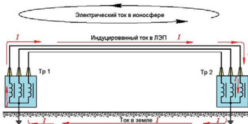
Рис. 5. Схема формирования и протекания ГИТ в ЛЭП [составлено с участием авторов].
