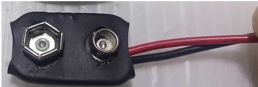
FIGURA A1.6. BROCHE DE BATERIA FUENTE: ELABORACIÓN PROPIA
