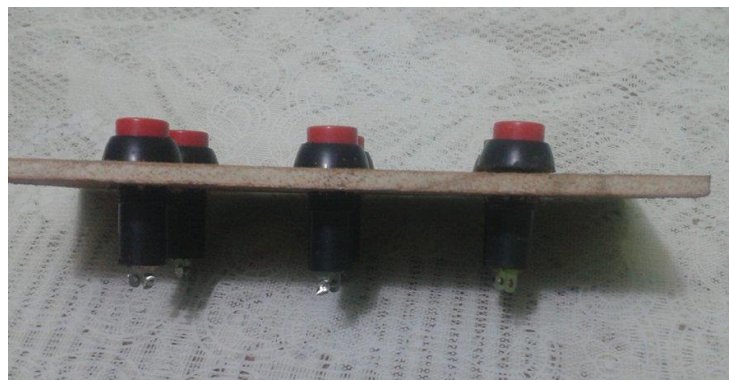
FIGURA 3.32. COLOCACIÓN DE PULSADORES FUENTE: ELABORACIÓN PROPIA
