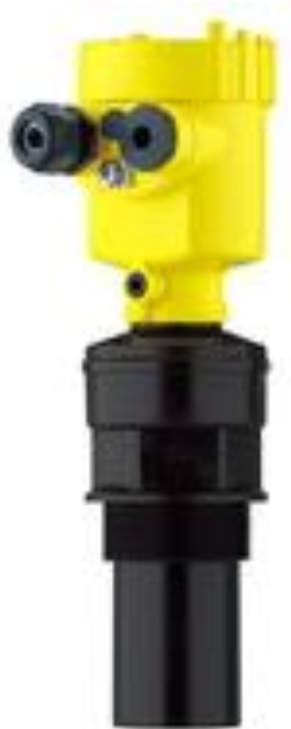
FIGURA 40 Sensor Ultrasonido VEGASON 62. 4 ..20 ma – 2 hilos Frecuencias bajas son usadas para largas distancias y usualmente nivel de sólidos y altas frecuencias son usadas para líquidos y distancias cortas.
