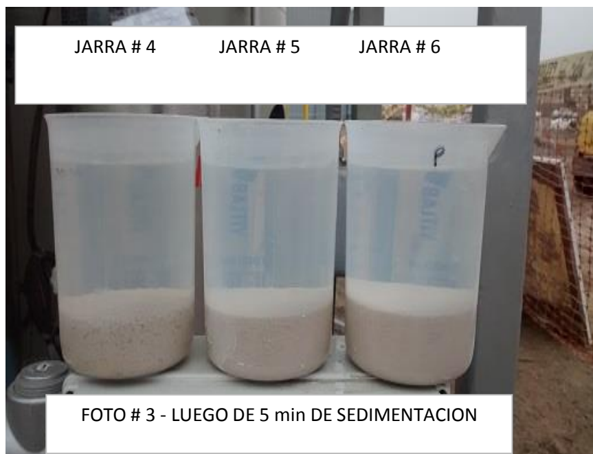
FIGURA 25 agua tratada por proceso químico de sedimentación
