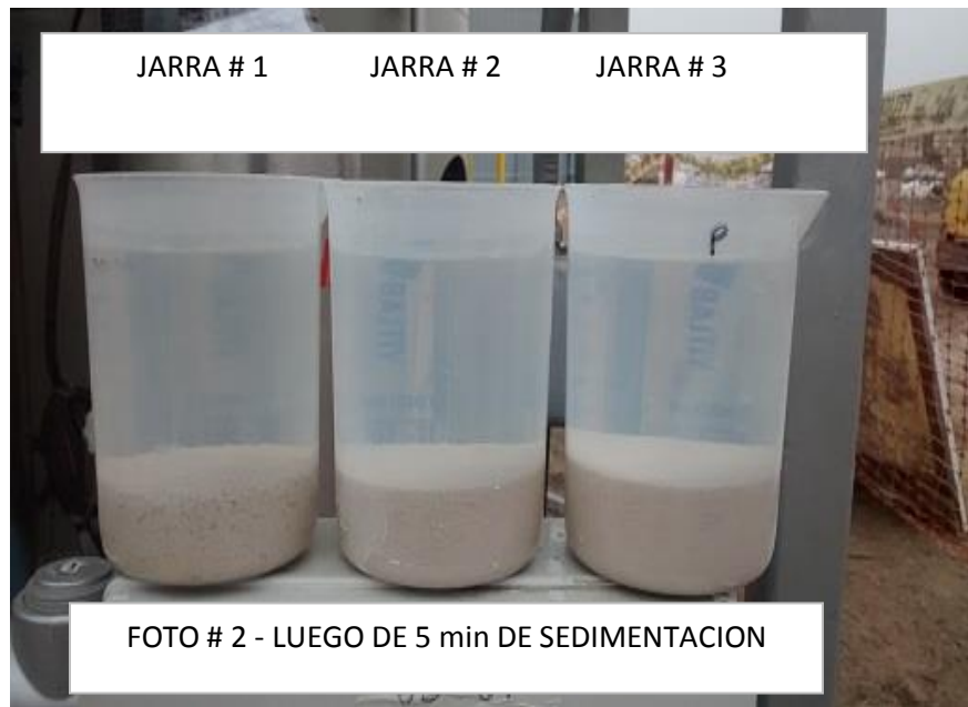
FIGURA 24 agua residual de planta cerámica con proceso de sedimentación química
