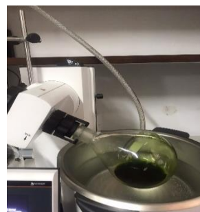
Gambar 1. Tahapan ekstraksi senyawa antioksidan dengan pelarut etanol dan pemekatan dengan rotary evaporator
