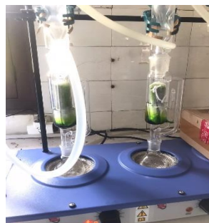
Gambar 1. Tahapan ekstraksi senyawa antioksidan dengan pelarut etanol dan pemekatan dengan rotary evaporator
