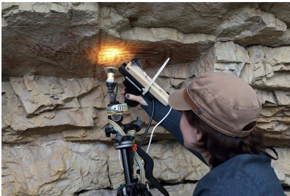
Fig. 1 – Réalisation d'une mesure en spectroscopie de réflectance diffuse
