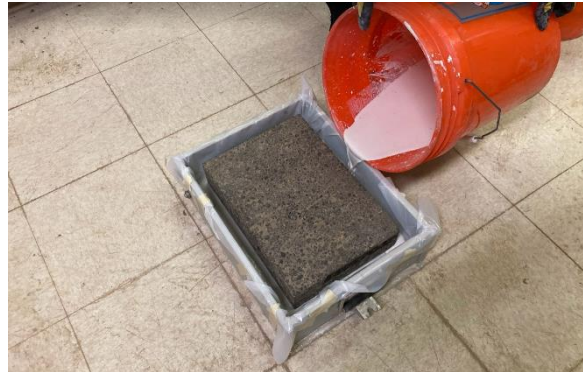
(d) Pouring plaster between mold and asphalt block
