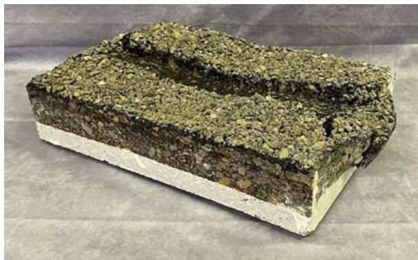
(d) Rectangular Modified CLRS, Freeze-Thaw & Chip Seal
