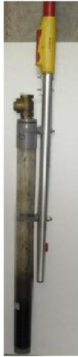
Figure 3. Système de carottage des sédiments.
