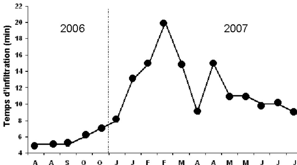
Figure 3. Évolution temporelle du temps d'infiltration de la lame d'eau dans le lit planté.
