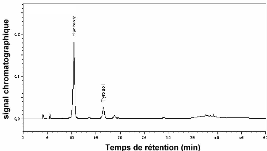
Figure 2. Analyse de HPLC de l'extrait phénolique des margines brutes.
