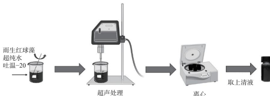
图1 水分散虾青素乳液制备流程图
