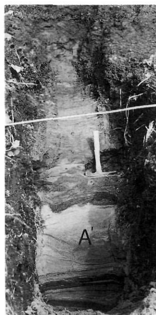
FIGURE 15. Sable fin jaunâtre interstratifié de lits de silt brunâtre sub-horizontaux (unité A', coupe 53-A). Saint-Pierre-les-Becquets.
