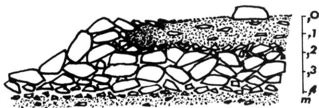
FIGURE 13. Coupe dans le front d'une coulée à front pierreux active. À noter le litage et le classement du matériel.
