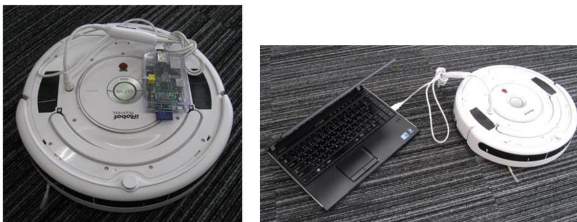
(a)小型移動ロボット+Raspberry Pi
