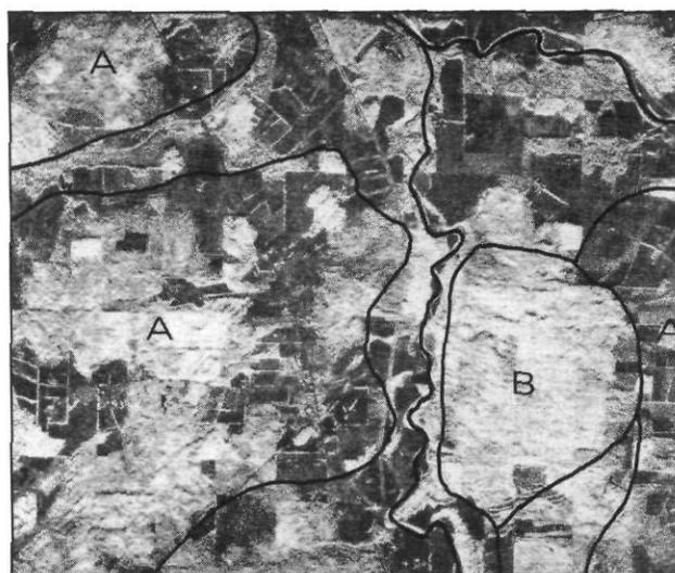
FIGURE 6b. Image radar à ouverture synthétique (1978-11-08): image XHV du secteur de Petit-Lac. A: interfluves commandés par le substratum rocheux; B: chenaux juxttaglaciers. Synthetic aperture radar image (1978-11-08): XHV image of Petit-Lac area. A: bedrock influenced interfluvial channels; B: in contact channels.
