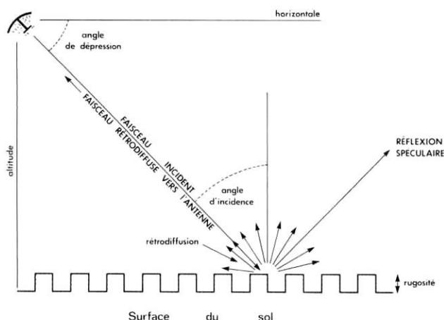
FIGURE 1. Principaux paramètres intervenant dans l'analyse des images radar latéral (d'après SABINS, 1978).
