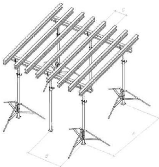
Рисунок 5.1 – Схема поддерживающих лесов
