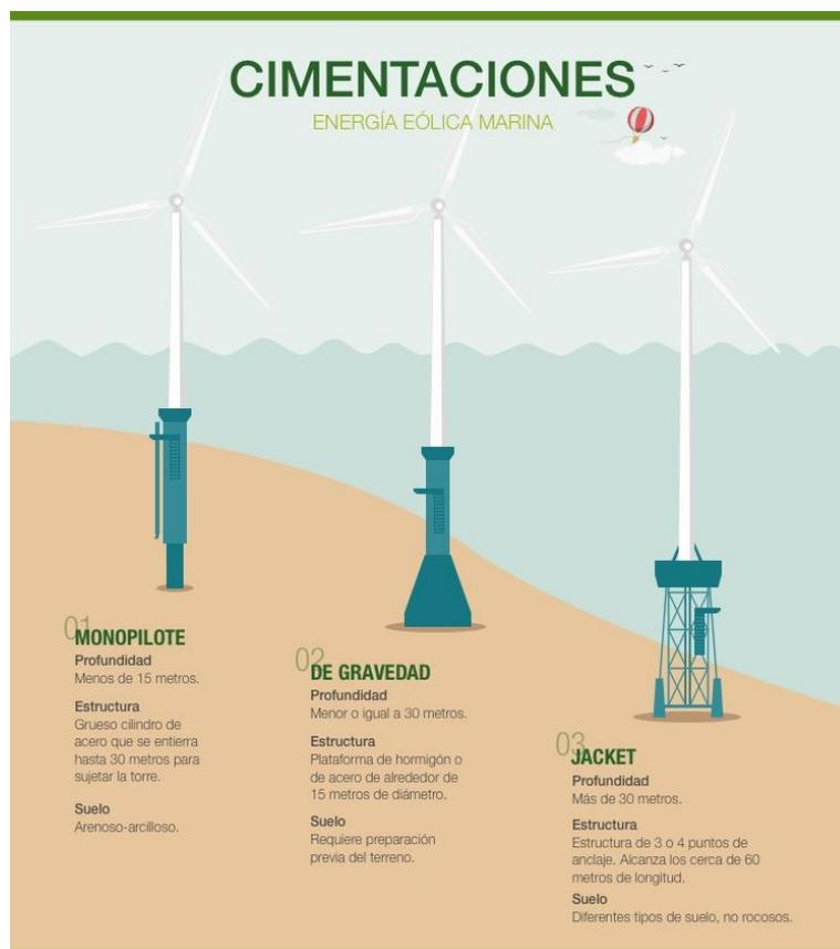
*Figura 34.- Tipos de cimentaciones fijas. (Iberdrola, Cimentaciones aerogeneradores marinos, s.f.)*
