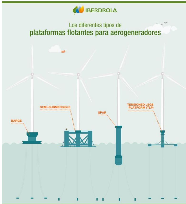
**Figura 35.-** Tipos de cimentaciones flotantes. (Iberdrola, Eólica marina flotante, s.f.)
