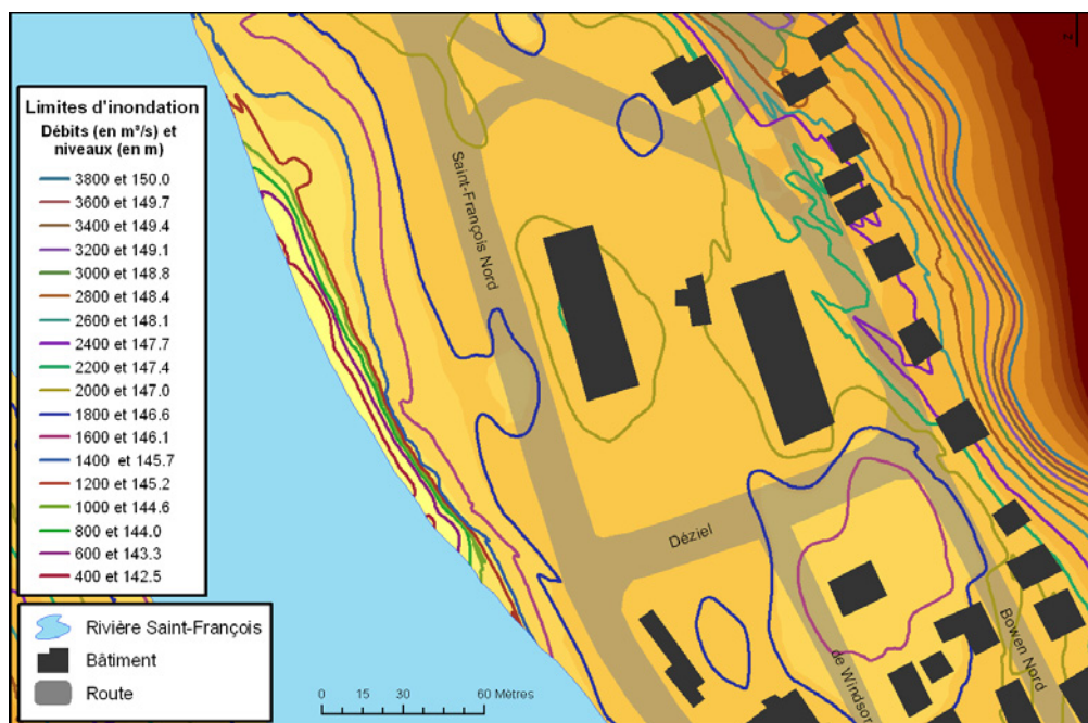
Fig. 9 — Les limites d'inondation en fonction de la variation des niveaux des débits (Site SHE-2)
