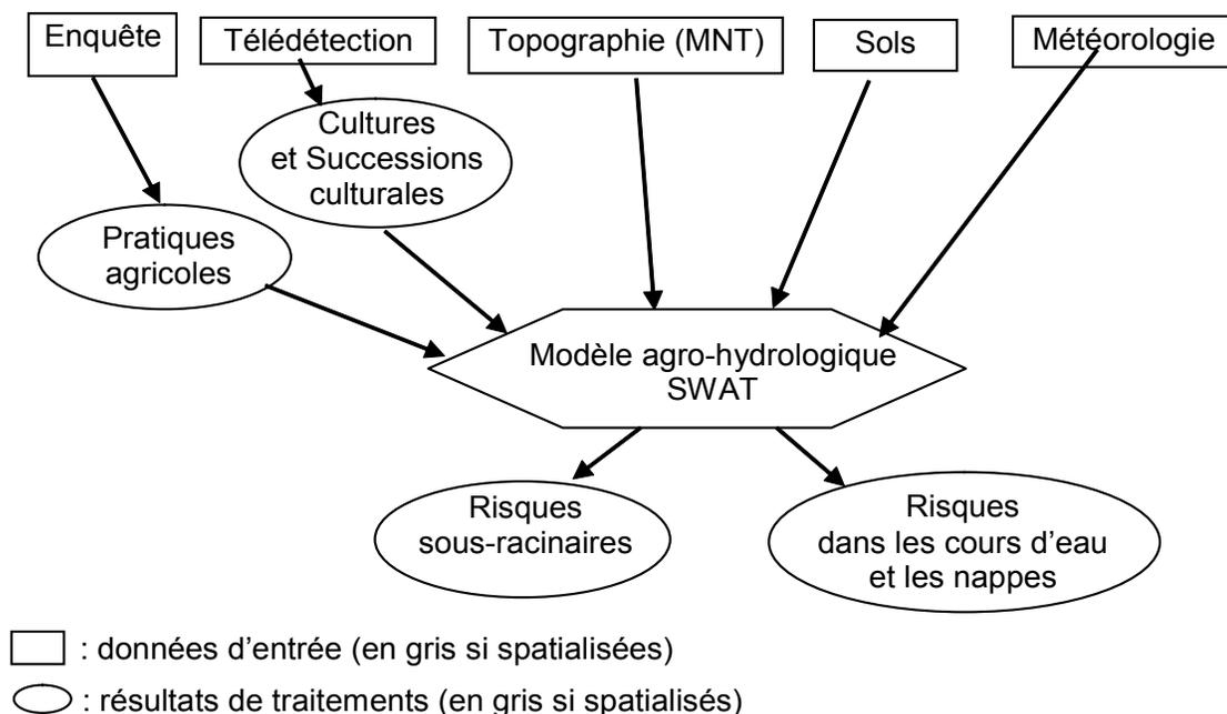
**Figure 3 : Schéma méthodologique de la mise en œuvre du modèle SWAT.**
