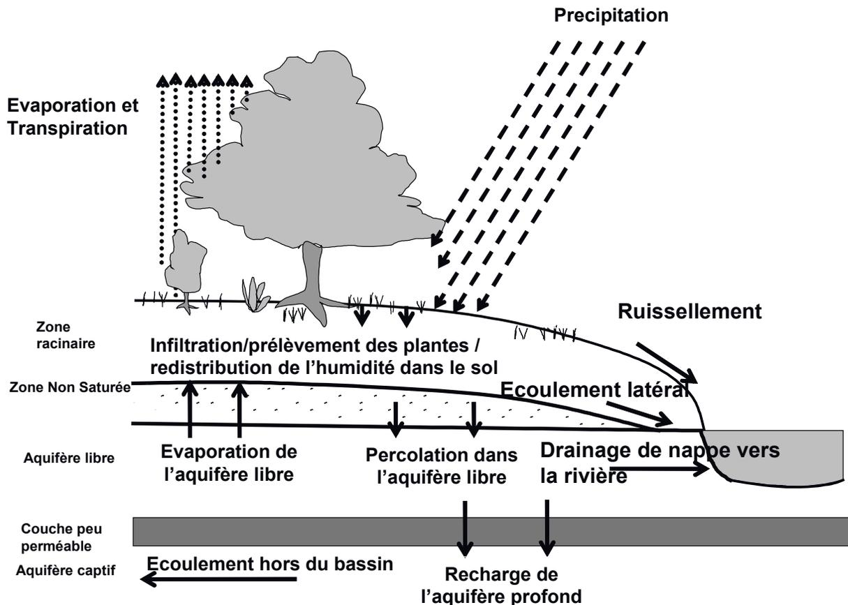
Figure 2 : Composantes hydrologiques du modèle SWAT.
