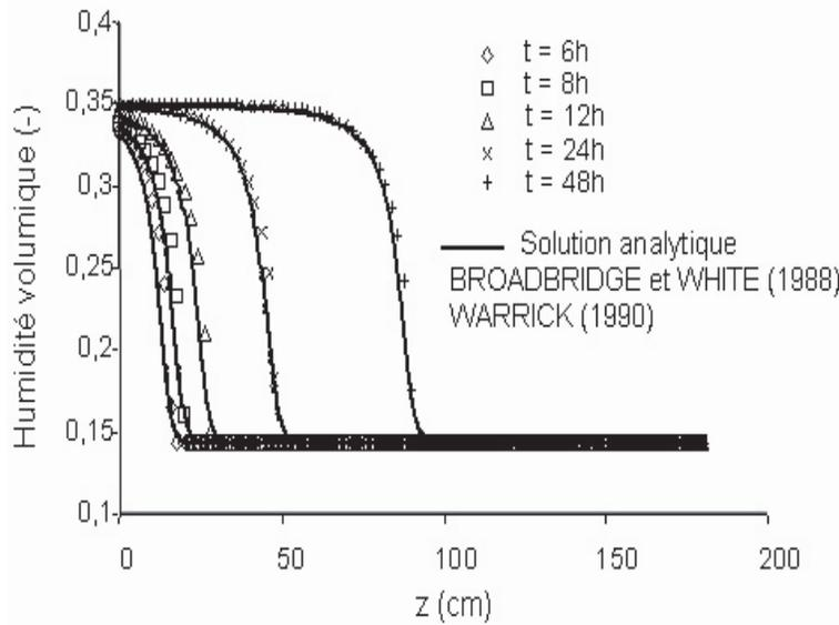
Figure 1 Comparaison des solutions analytiques de l'équation de Richards et celle du modèle développé pour un débit de 8,64 cm/j.
