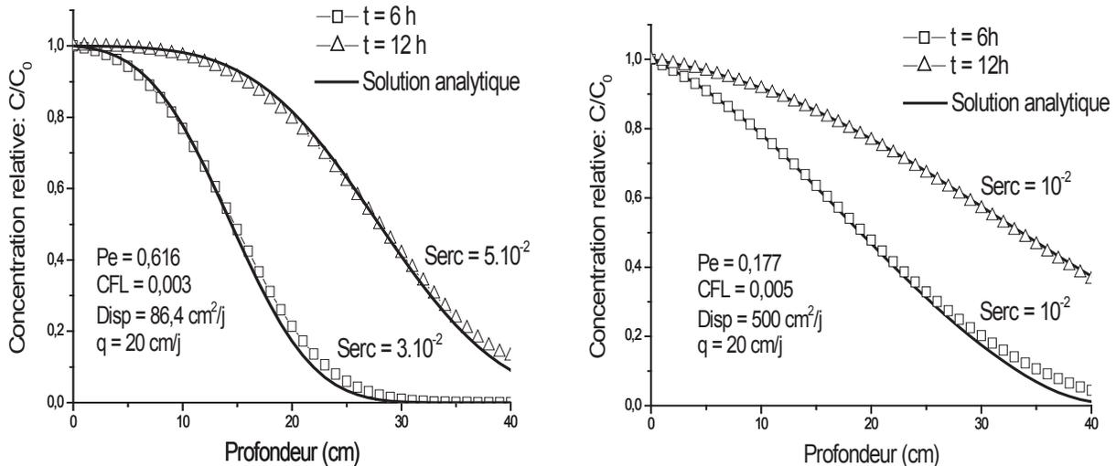
Figure 2 Convection-dispersion d'un soluté dissous sans réaction chimique.
