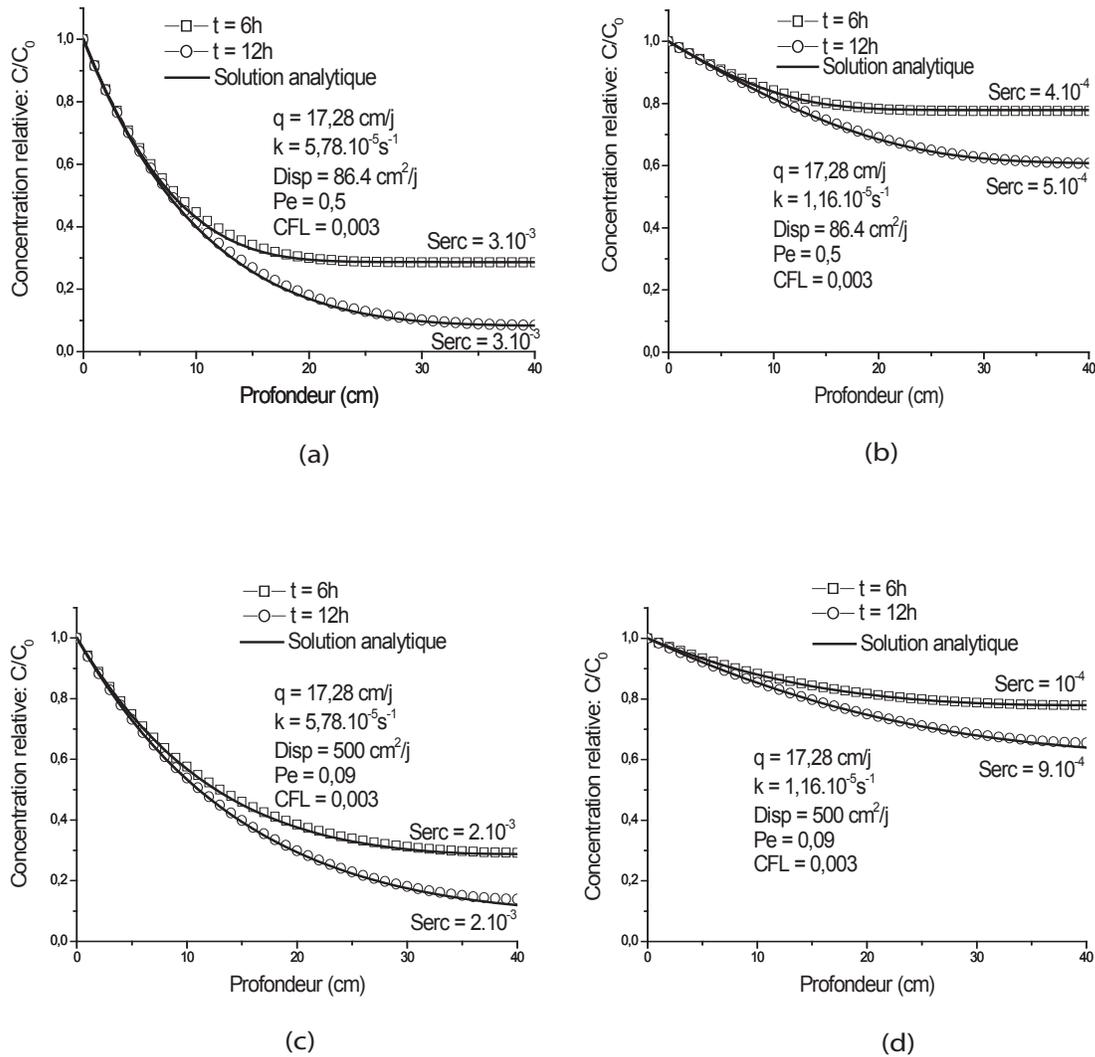
**Figure 3** Illustration de l'effet conjugué de la dispersion et du taux de dégradation du substrat.
