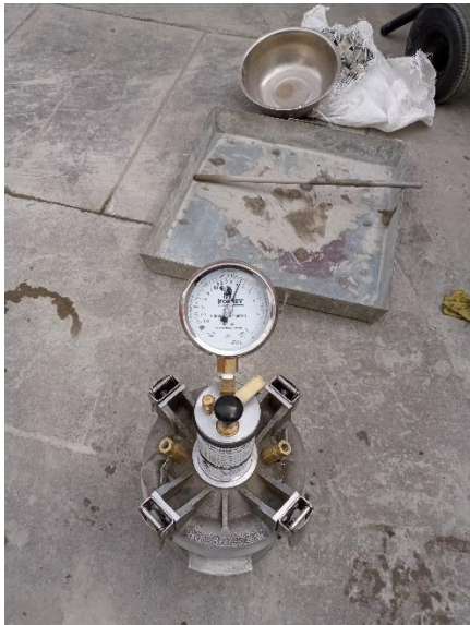
Olla Washington para medir el Contenido de aire del concreto
