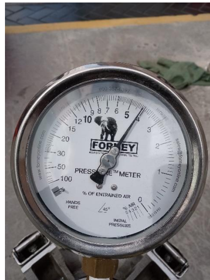
Medidor de presión de la Olla Washington marcando el Contenido de aire
