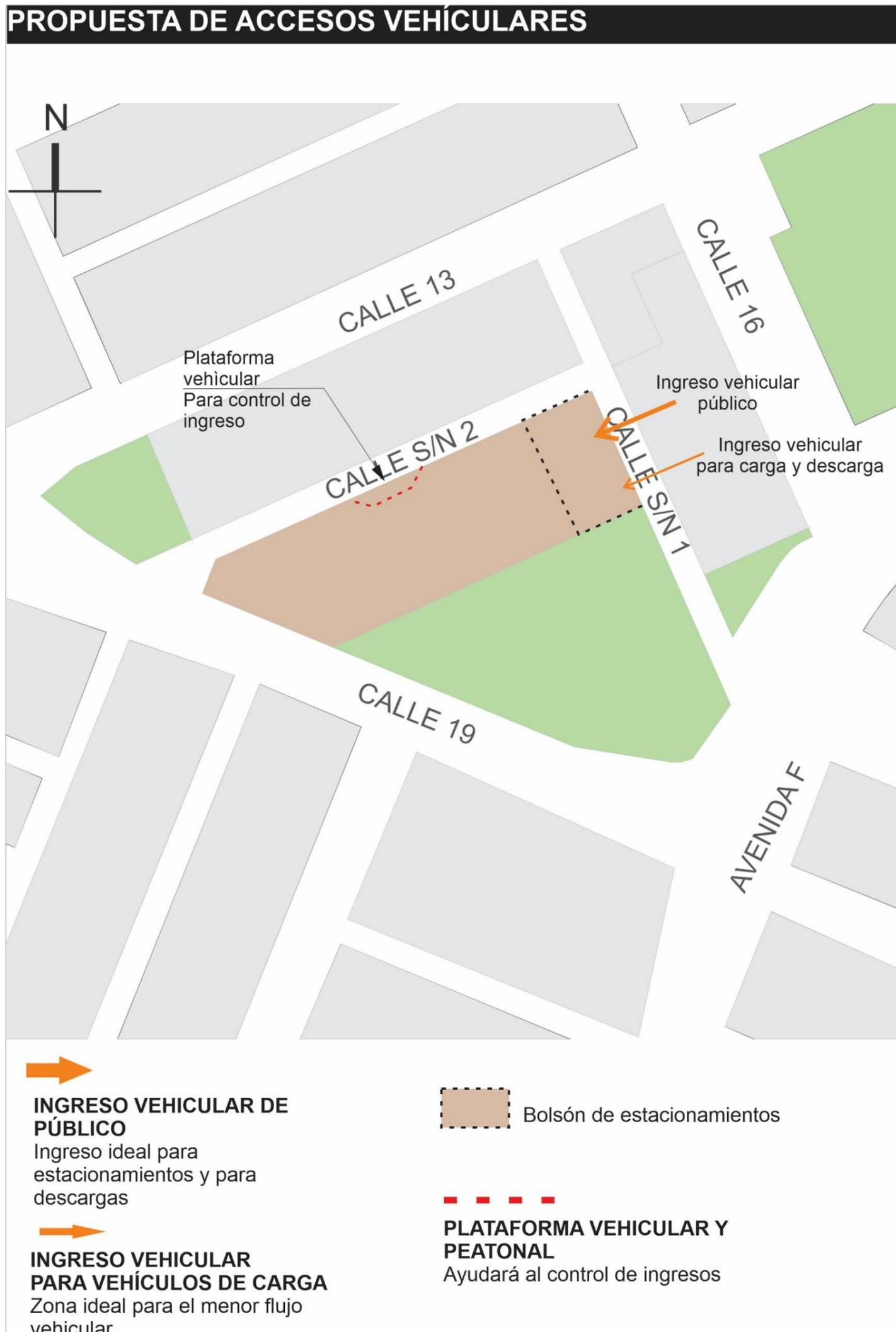
*Nota.* El gráfico muestra propuestas de los accesos vehiculares dentro del terreno, mediante una plataforma vehicular para controlar el tráfico por la calle S/N 2 y se plantean dos ingresos vehiculares tanto para vehículos de público y personal como para carga y descarga. Elaboración propia.
