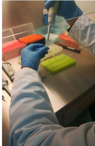
**Fotografía N° 12.** Proceso de pre-PCR; preparación del MASTER MIX para la PCR HRM.
