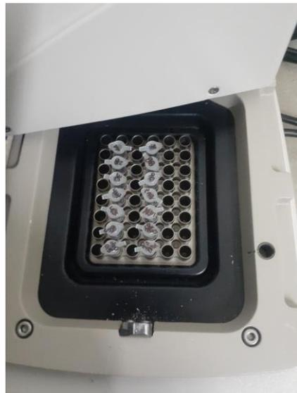
**Fotografía N° 13.** Colocación de los criotubos en el termociclador MiniOpticon *Real Time* PCR System para la PCR HRM.
