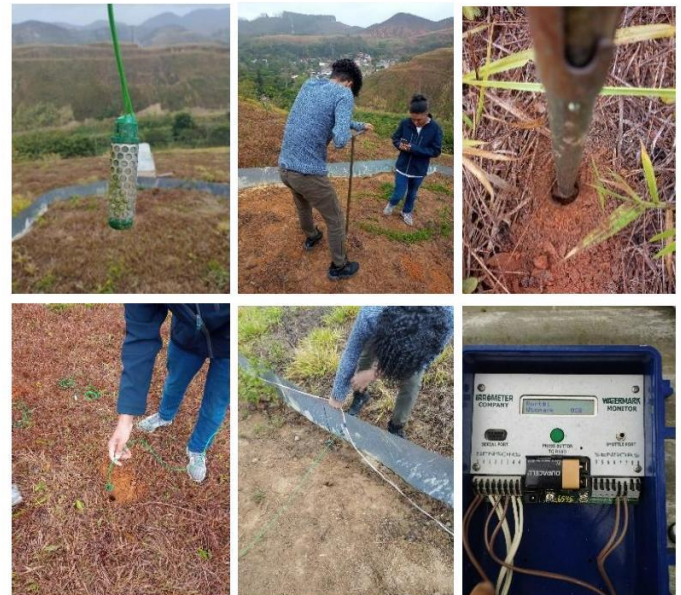
Figura 4. Instalação dos sensores GMS no interior das parcelas. Fonte: O autor (2022).
