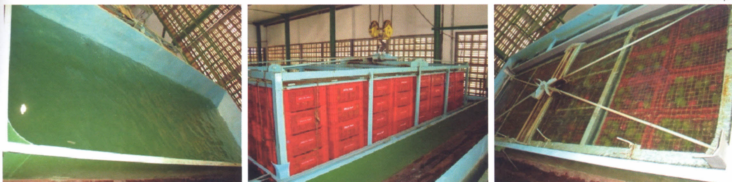
Figura 2 - Fases do tratamento hidrotérmico de mangas no VSF, mostrando o tanque com água aquecida, o contêiner contendo as mangas sendo içado para ser colocado dentro do tanque e o container com as mangas já submerso
