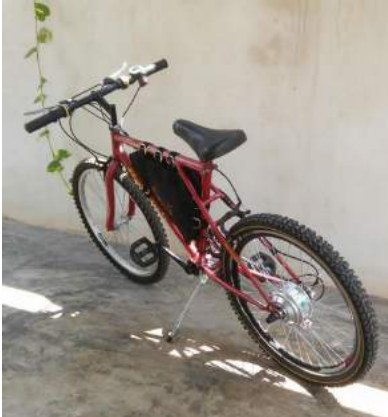
Imagen 4. Bicicleta reconstruida rodada 24 con motor eléctrico (modelo para la medición longitudinal del rendimiento).
