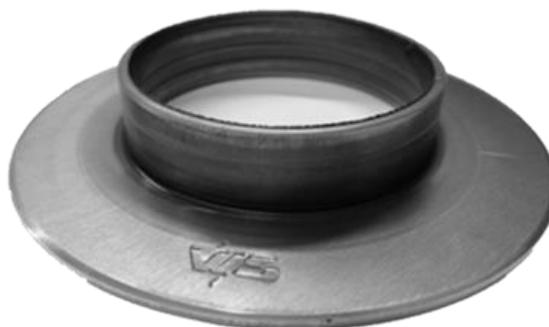
Abbildung 93: Mittels der kombinierten Prozessroute hergestellte Demonstratorgeometrie aus hochfestem Aluminium
