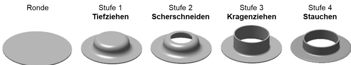
Abbildung 25: Vierstufige Stadienfolge zur Herstellung einer Demonstratorgeometrie mit angepassten Wanddicken [Gue23<sup>E</sup>]
