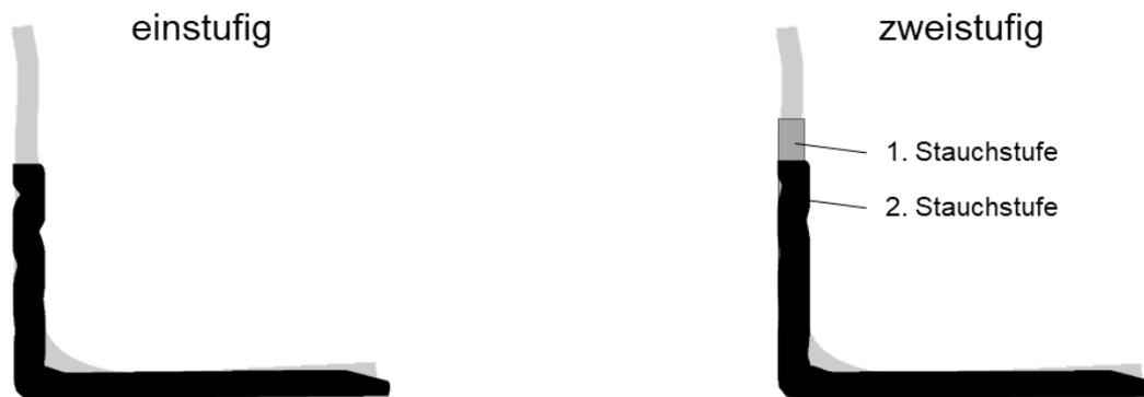
Abbildung 74: Numerische Optimierung der Konturgenauigkeit durch ein zweistufiges Stauchen am Beispiel von EN AW-7075-W (nach [Web22<sup>S</sup>])
