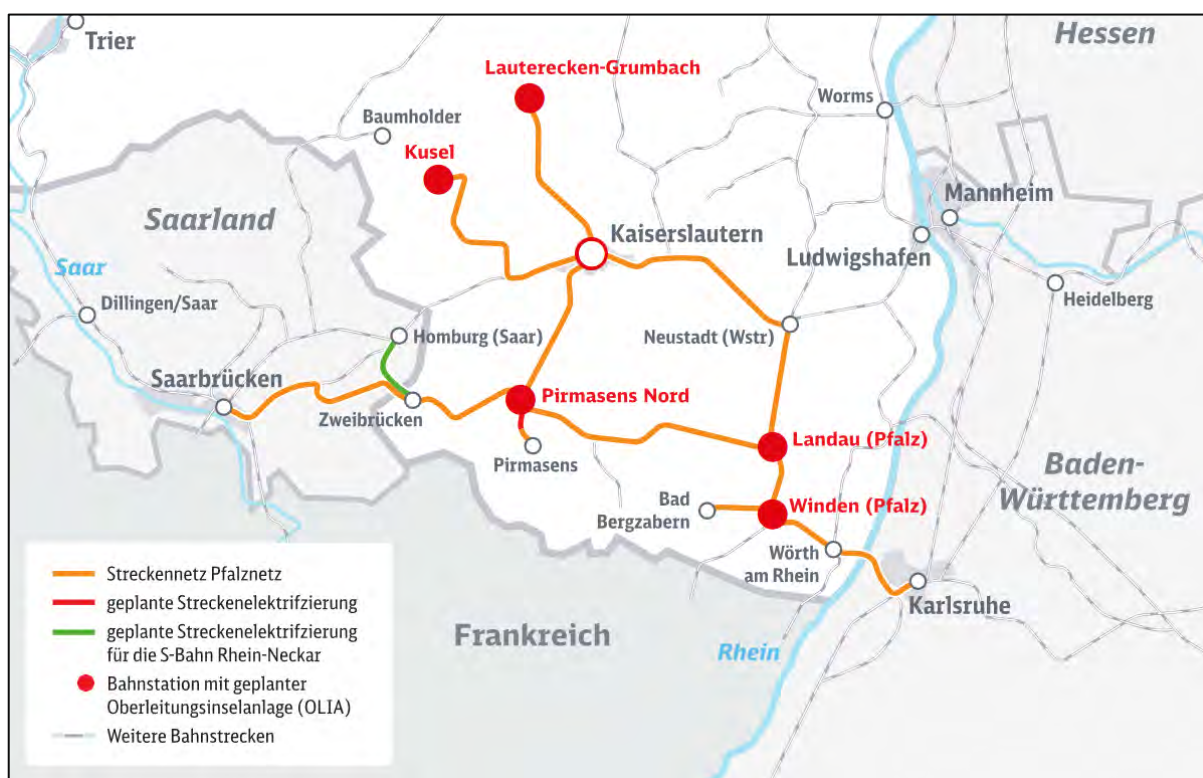
Figure 16: Map showing the planned electrification for Pfalznetz within the Pfalznetz BEMU electrification plan [49]. Translation of legend German to English: Streckennetz Pfalznetz = Rail network Pfalznetz, geplante Streckenelektrifizierung = Planned rail network electrification, geplante Streckenelektrifizierung für die S-Bahn Rhein-Neckar = Planned rail network electrification for the S-Bahn Rhein-Neckar, Bahnstation mit geplanter Oberleitungsinselange (OLIA) = Railway station with planned catenary island, Weitere Bahnstrecken = Other railway lines.
